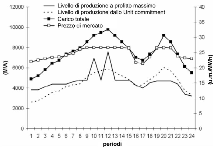
Fig. 1. Società price taker: confronto fra i livelli di produzione complessiva calcolati mediante il tradizionale programma di unit commitment che minimizza i costi di produzione totali del sistema, e quelli calcolati mediante la procedura di massimizzazione dei profitti assumendo i prezzi mercato pari ai moltiplicatori di Lagrange del vincolo di soddisfacimento della domanda. (u.m. = generica unità monetaria)
